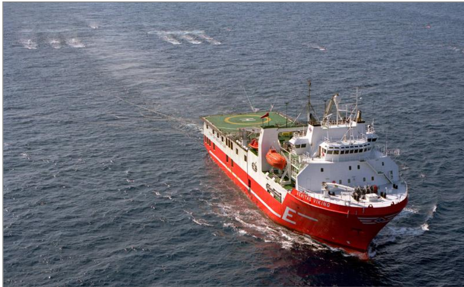
Figura 2.11 – Esempio di nave per acquisizione sismica durante l’acquisizione (fonte: www.gas-naturale.ch/gas-naturale/estrazione ).
