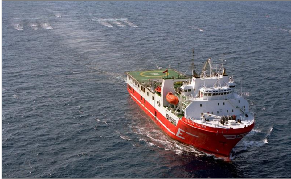
Figura 3.16 – Esempio di nave per il rilievo sismico durante l’acquisizione (fonte: www.gas-naturale.ch/gas-naturale/estrazione ).
