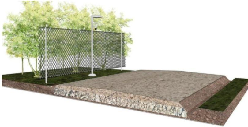
Figura 18. Recinzione perimetrale e pista di impianto
