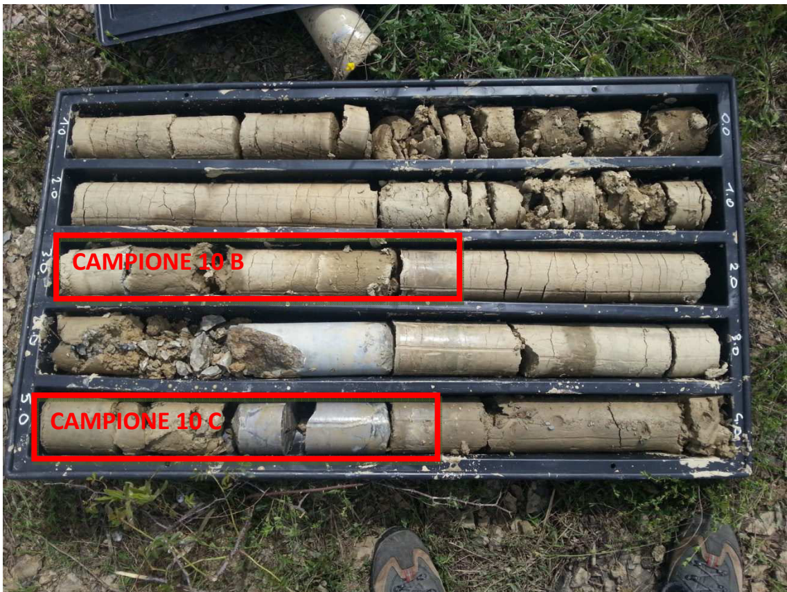
Sondaggio 10 da 0 m a 5 m
