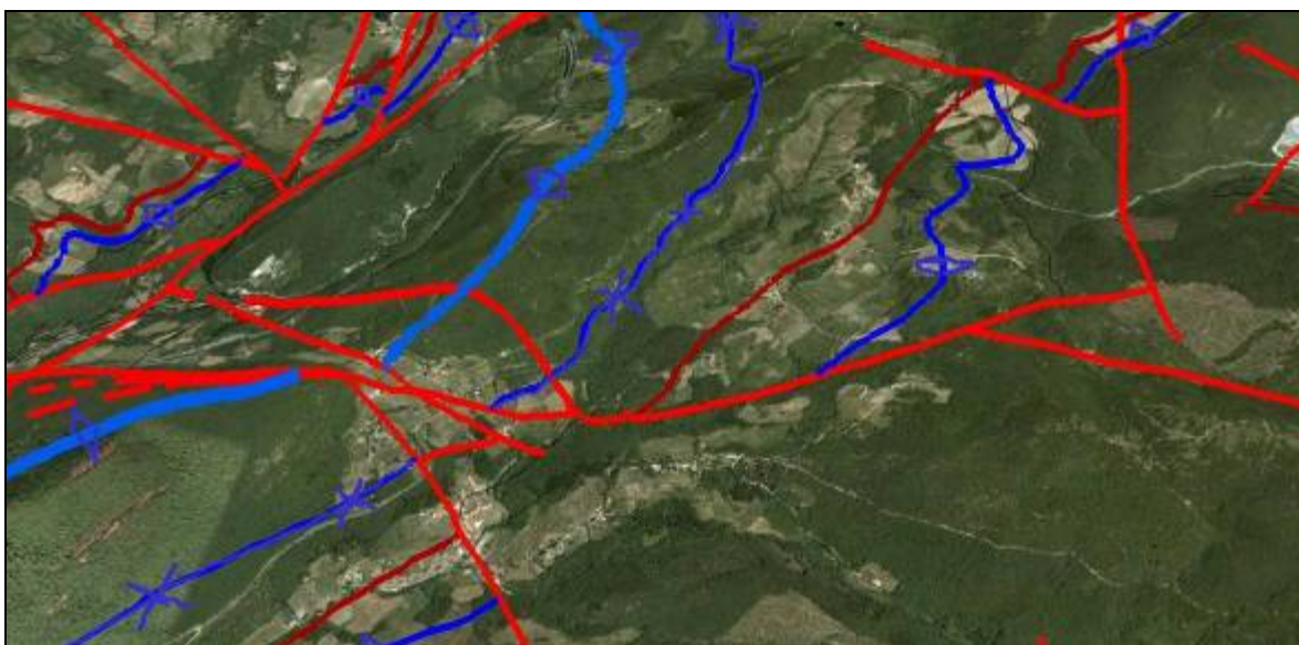
Fig. 3 - Panoramica della dorsale di Poggio Bucine-Montrotti-Montenignano con evidenziate le principali strutture tettoniche; in rosso faglie normali e sovrascorrimenti, in blu tracce di piani assiali di sinclinali ed anticlinali, per dettaglio vedi Cartografia geologica.
