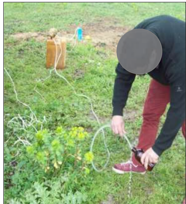
FOTO 27/28 – Fasi di esecuzione dello spurgo e del prelievo campioni d'acqua.
