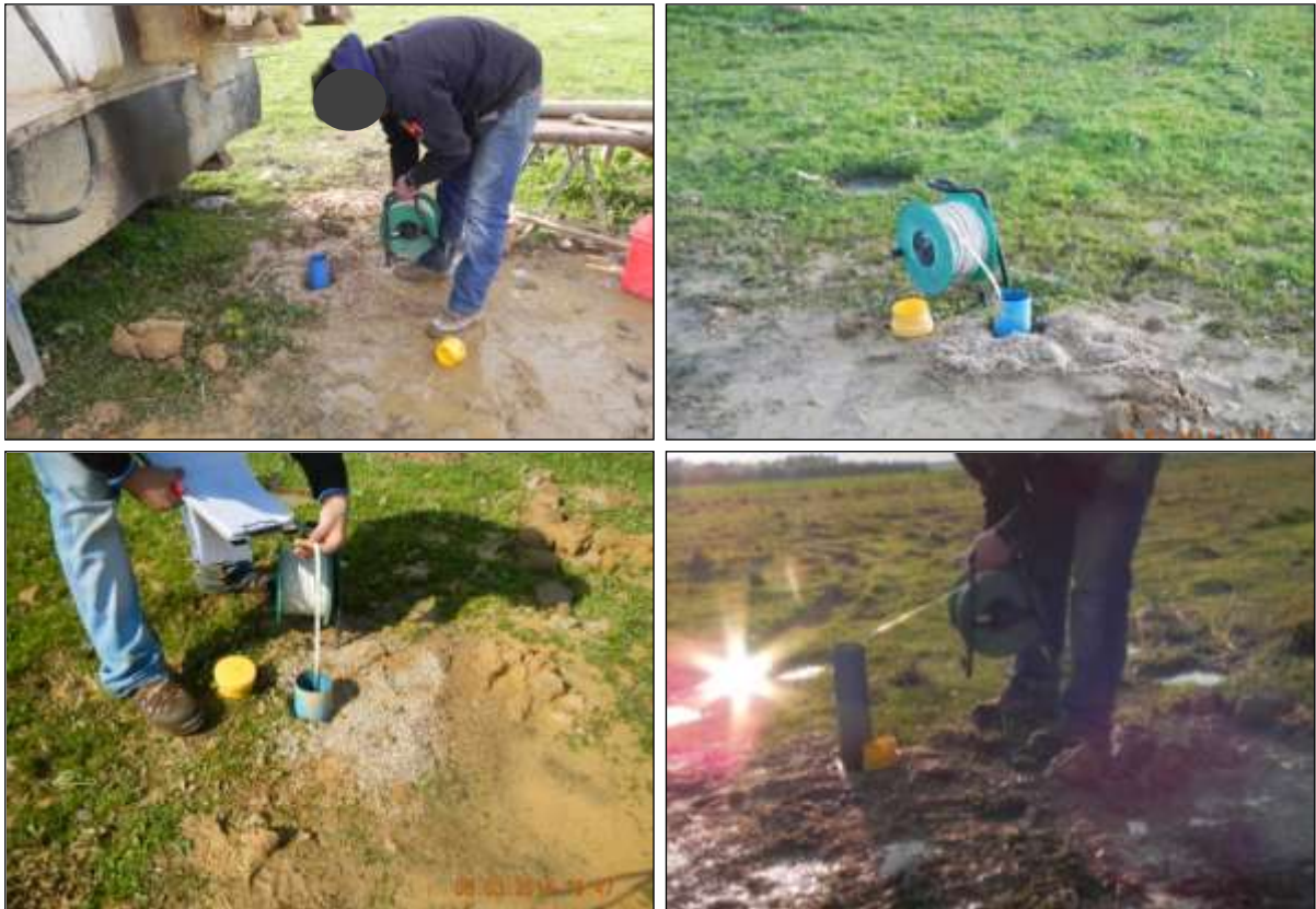
FOTO 20÷23 - Rilievo del livello idrico entro i tubi piezometrici.
