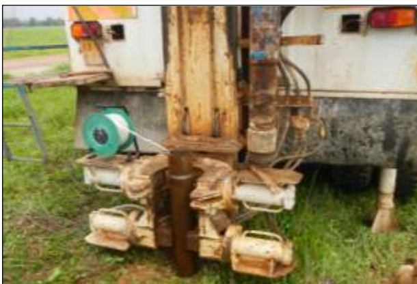
FOTO 5 - Particolare della morsa.
