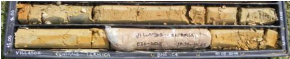
FOTO 39 – Sabbie fini limose [D1] estratte dal sondaggio BH6 (15,00-17,00 m da p.c.).
