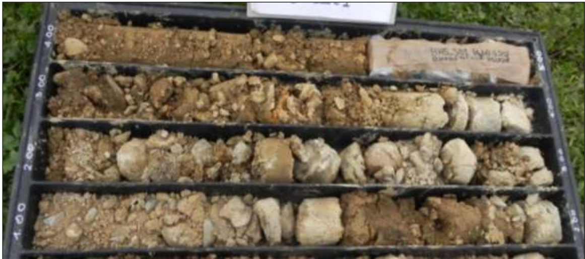
FOTO 35 – Ghiaie ciottolose in matrice sabbioso-limosa estratte dal sondaggio BH6 .
