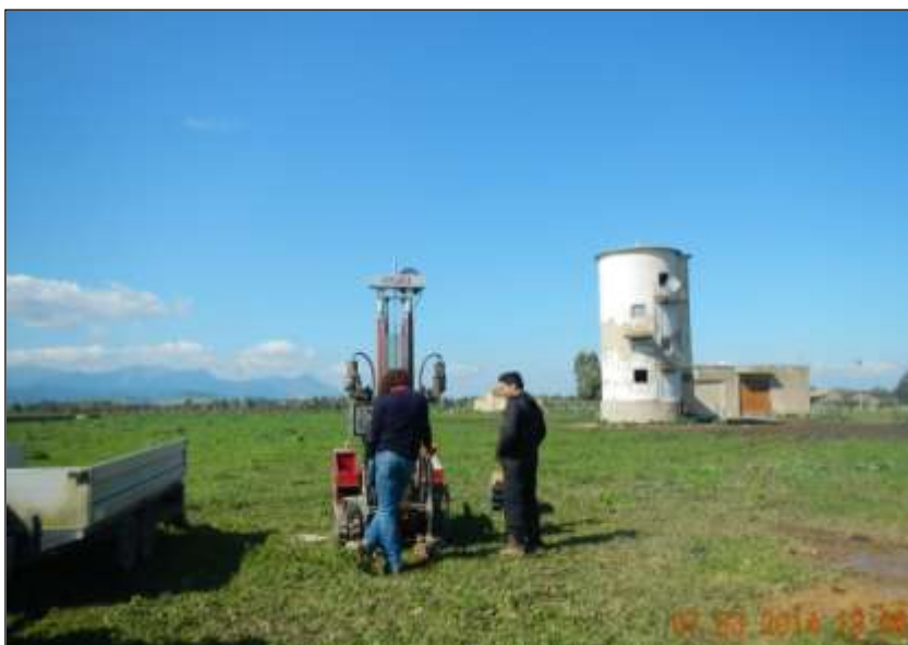
FOTO 14 Penetrometro pesante impiegato.
