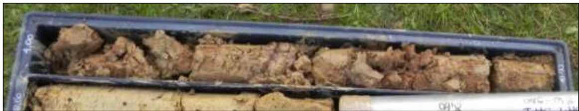
FOTO 40 – Sabbie grossolane [D2] estratte dal sondaggio BH1 (9,00-10,00 m da p.c.).
