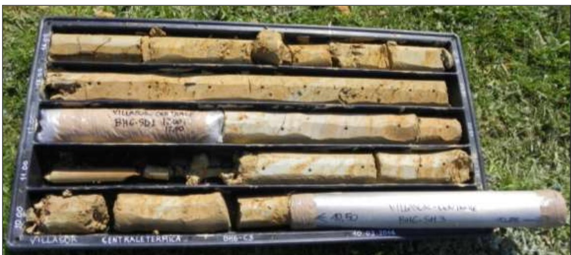
FOTO 36 – Sedimenti dello Strato C estratte dal sondaggio BH6 (10,00-15,00 m da p.c.)
