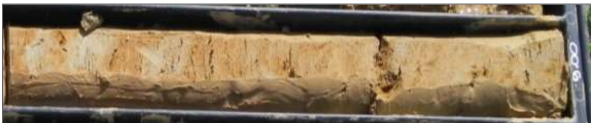
FOTO 38 – Particolare limi sabbioso-argillosi [C1] del sondaggio BH2 (8,50÷9,00 m da p.c.)
