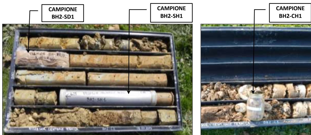
FIGURA 9 - Campioni di terreno prelevati per analisi geotecniche e per analisi chimiche.
