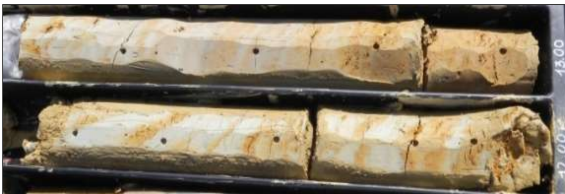
FOTO 37 – Particolare argille limose [C2] del sondaggio BH6 (11,50÷12,00 m e 12,50÷13,00 da p.c.).
