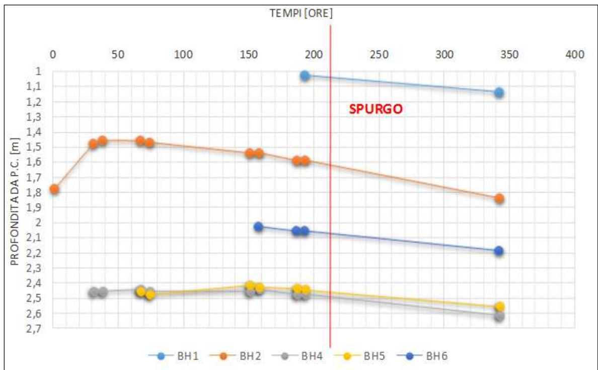
FIGURA 31 – Andamento del livello della falda rilevato nel corso della campagna geognostica.
