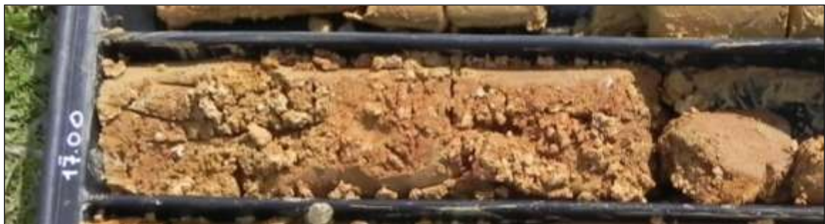
FOTO 41 – Sabbie microghiaiose arrossate [D2] estratte dal sondaggio BH6 (17,00-17,40 m da p.c.).
