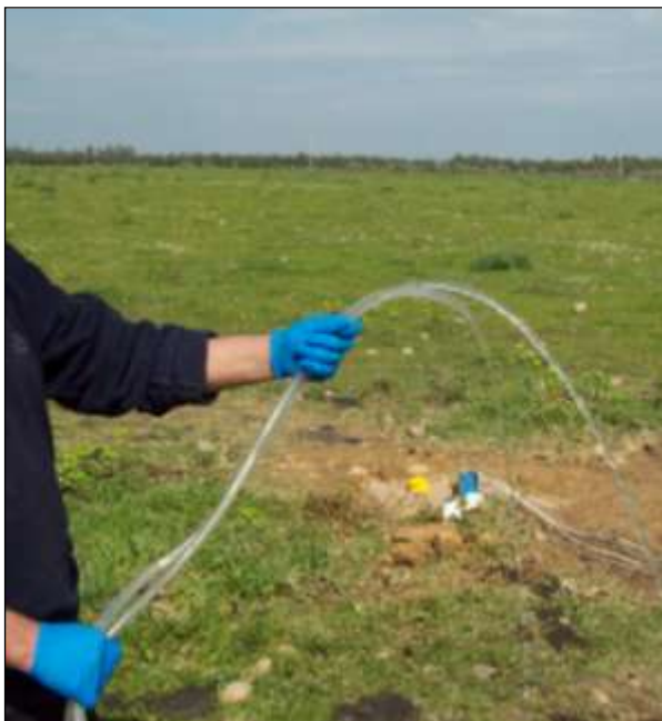
FOTO 27/28 – Fasi di esecuzione dello spurgo e del prelievo campioni d'acqua.
