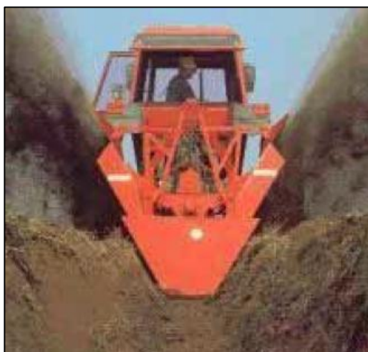
Figura 15: Esempio macchinario per la realizzazione delle scoline
