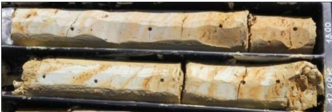
**FOTO 7** – Particolare argille limose [C2] del sondaggio **BH6** (11,50÷12,00 m e 12,50÷13,00 da p.c.).
