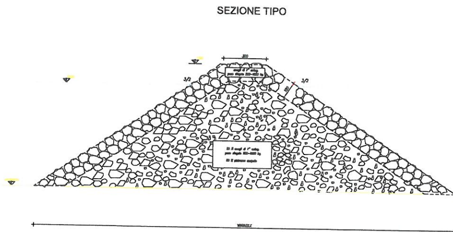
Figura 5.2 - Scogliera di difesa darsena ponente del porto di Porto Empedocle – Sez. Tipo
