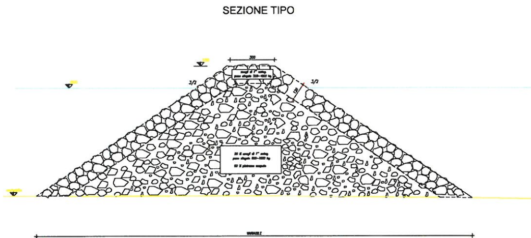
Scogliera di difesa darsena ponente del porto di Porto Empedocle – Sez. Tipo
