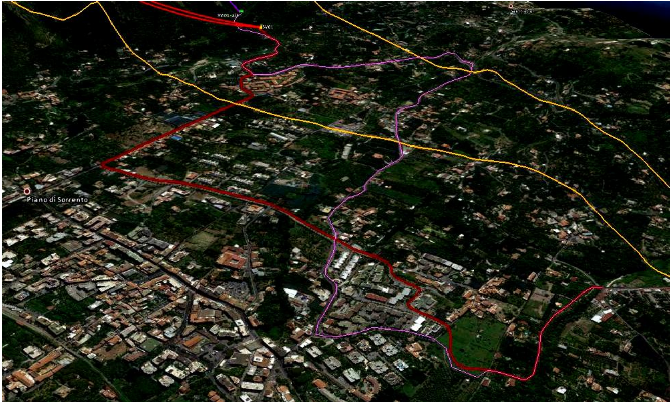
Figura 6 – In rosso lo sviluppo del cavo del tracciato A, in rosa quello dell'alternativa B
