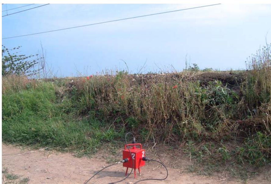
Figura 4.9-36 Postazione di misura a margine della linea ferroviaria Milano - Verona - posizione d = 6 m
