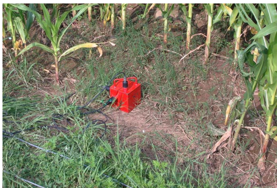
Figura 4.9-37 Postazione di misura a margine della linea ferroviaria Milano - Verona - posizione d = 24 m
