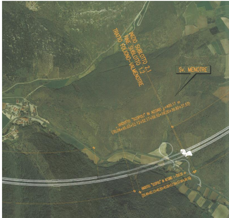
Figura 7-2 Schematizzazione dello svincolo di Scopoli/Menotre, ipotesi progettuale del 2007
