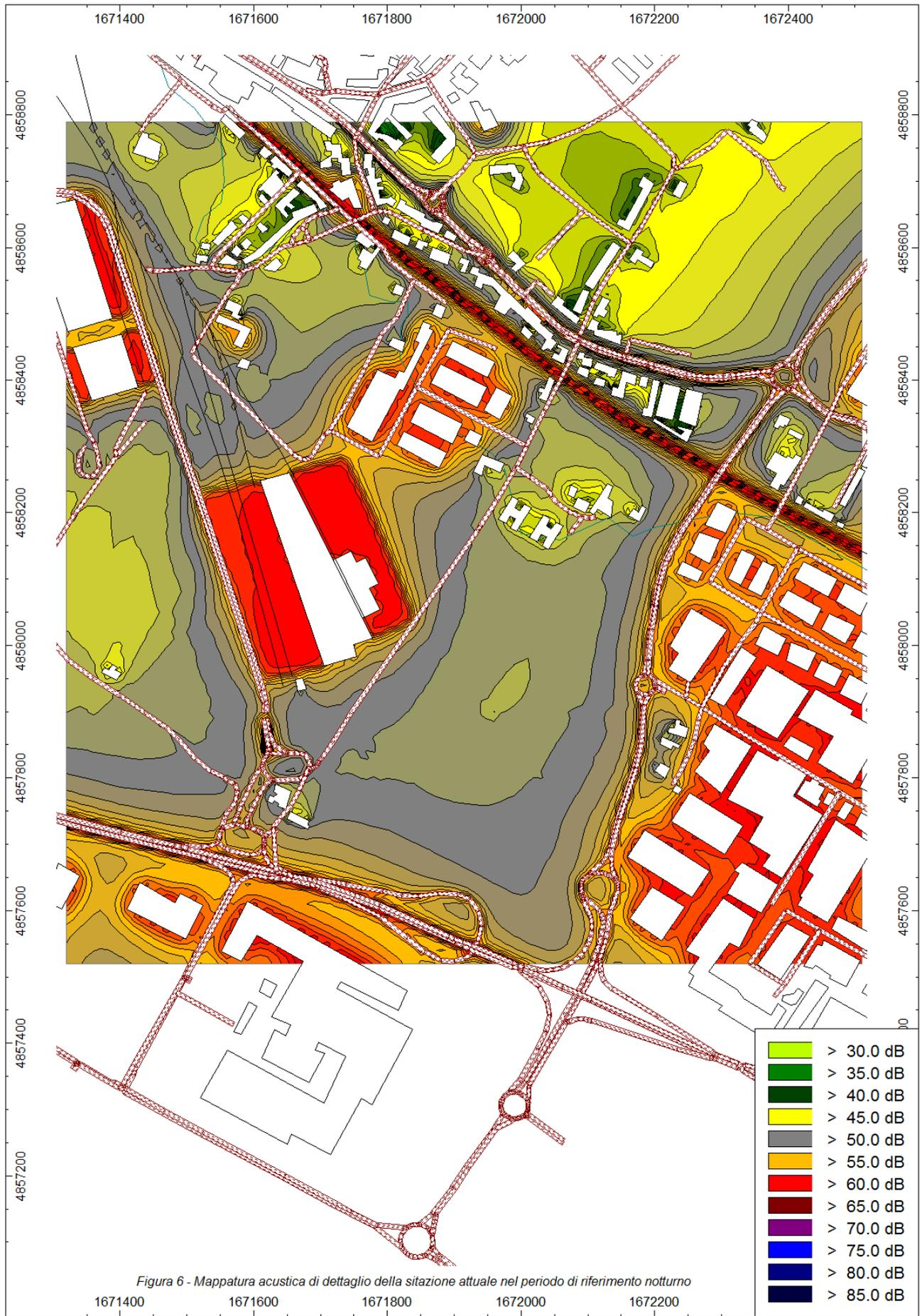
Figura 6 - Mappatura acustica di dettaglio della situazione attuale nel periodo di riferimento notturno
