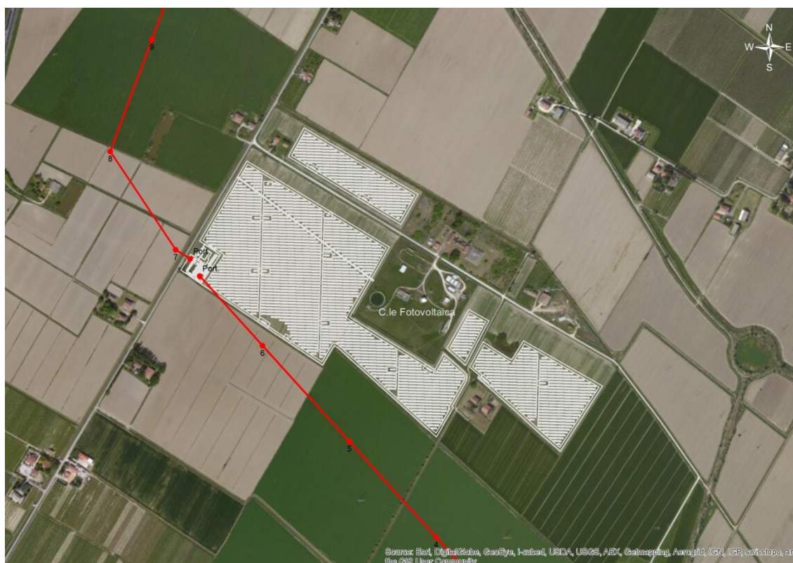
Connessione definitiva c.le Ferrara Aranova con due collegamenti a 132 kV in entra-esci
