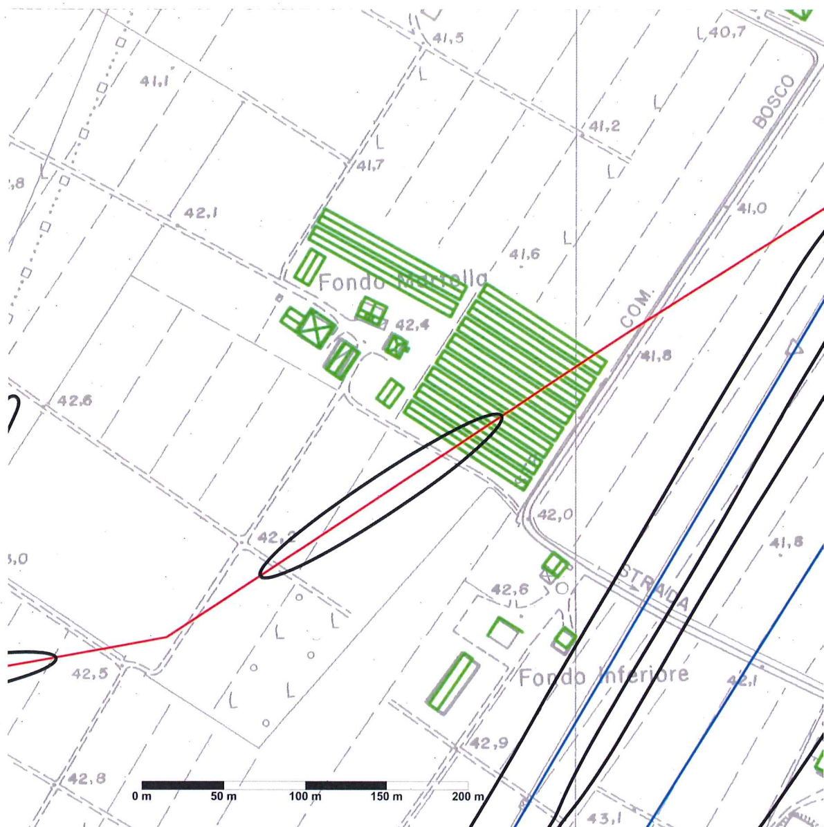
Figura 21 - Curve isolivello del campo magnetico a 3 \mu\text{T} , in nero, alla quota di 48 m slm nella zona dell'interferenza C.
