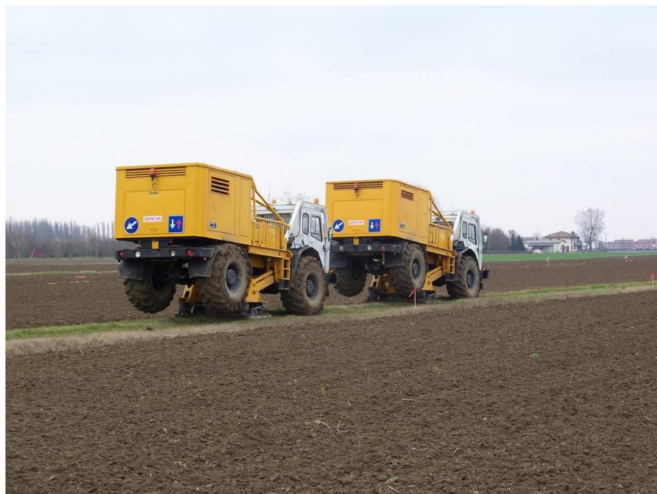
Fig. 9: Vibroseis durante la fase di acquisizione
