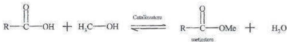
Figura 1 - Meccanismo generale di formazione del metilestere
