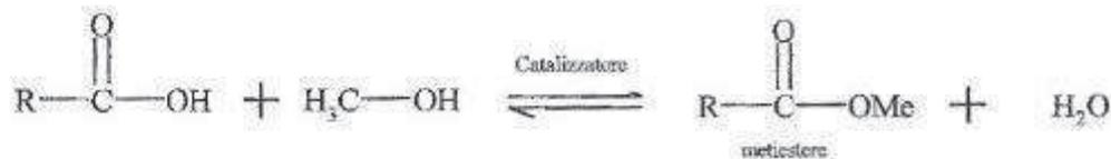
Figura 2 - Meccanismo generale di formazione del metilestere
