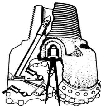
Figura 2.8: scalpello di perforazione
