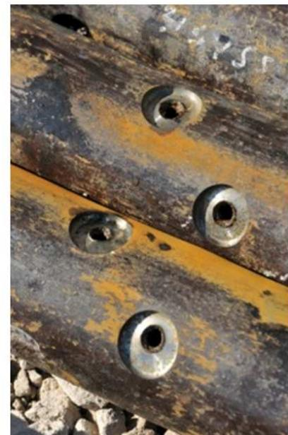
**Figura 3-36:** fucili perforatori al termine delle operazioni di sparo
