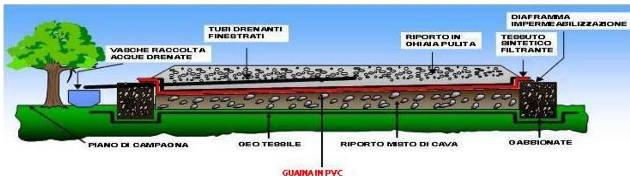
Figura 3-10: sezione schematica tipica di una piazzola di perforazione
