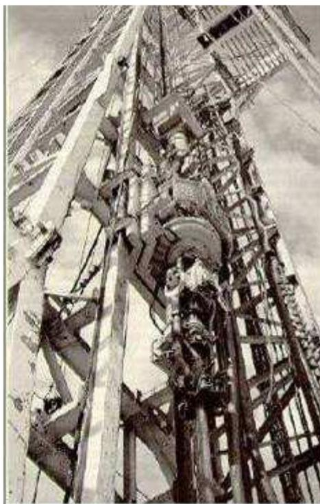
**Figura 3-15: impianto di Perforazione – Top Drive System**
