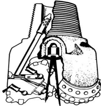
**Figura 3-11: scalpello di perforazione**
