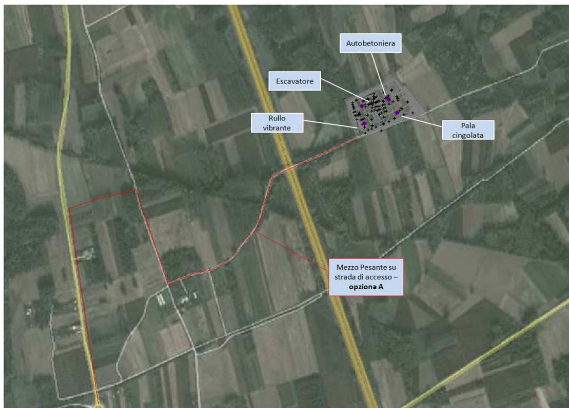
Figura 5-9: individuazione delle sorgenti sonore in fase di cantiere e strada di accesso – opzione A
