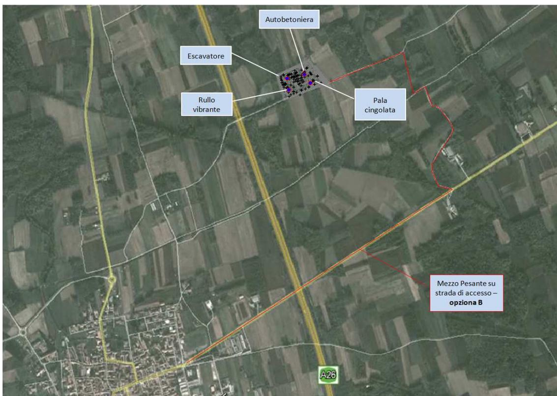
Figura 5-10: individuazione delle sorgenti sonore in fase di cantiere e strada di accesso – opzione B
