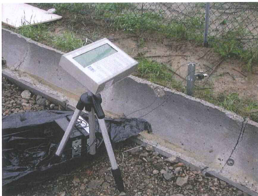
Foto 1 – La catena di misura basata sul modello 2900 della Larson & Davis
