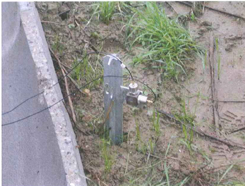
Foto 4. Punta metallica usata per le misure delle vibrazioni
