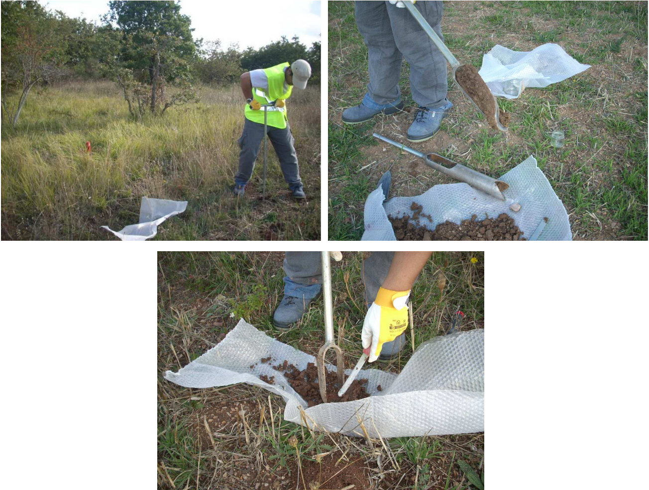
Figura 7-2: attività di campionamento tipo effettuate mediante trivella manuale
