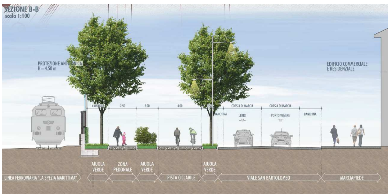
FIGURA 6-1 – SEZIONE TIPOLOGICA INTERVENTO DI PROGETTO
