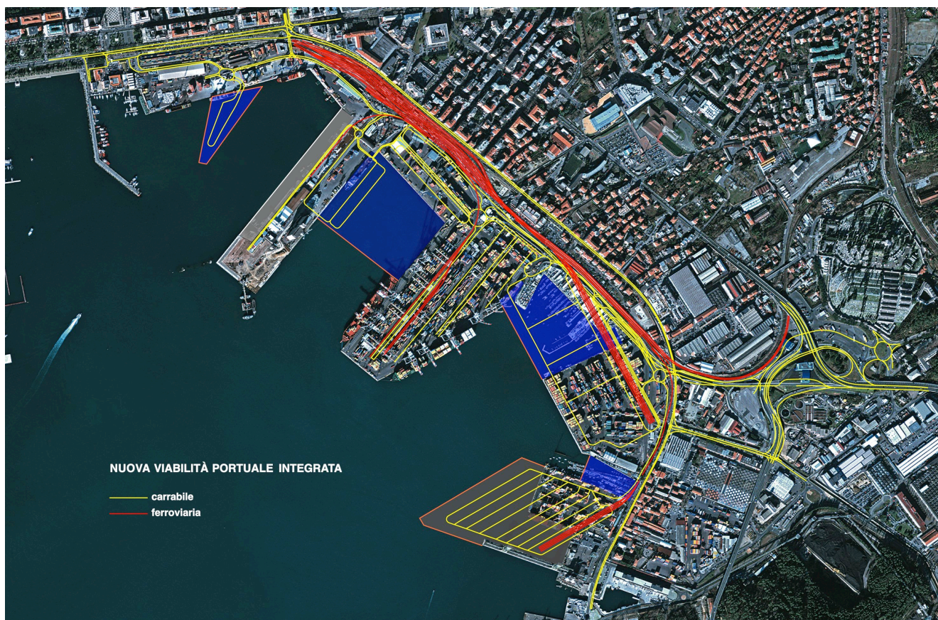
Figura 2 - nuova gronda portuale - in basso a sinistra è visibile il layout di massima dell'ampliamento di TDG con l'accesso dal diffusore
