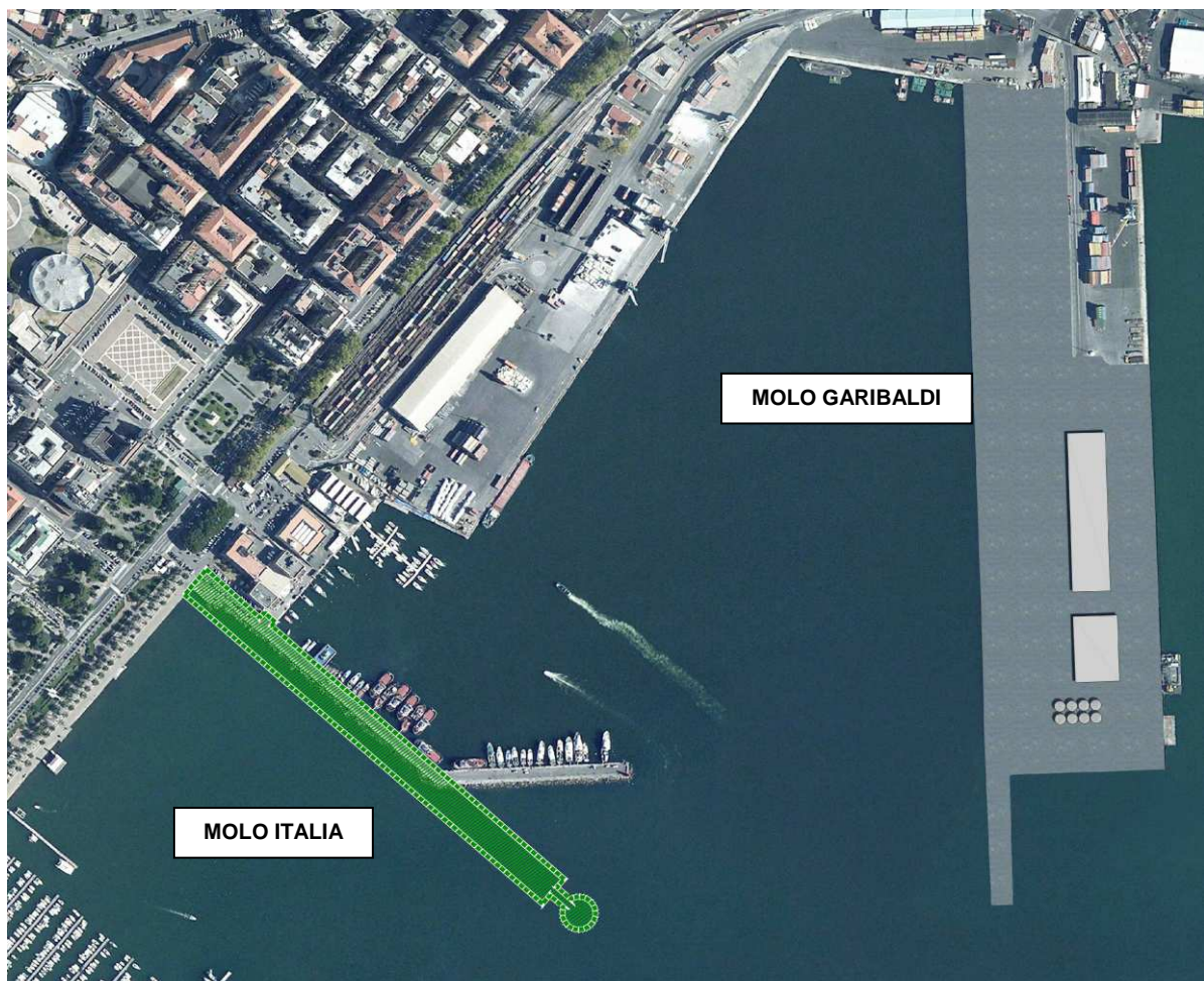
Figura 5-6 –Raddrizzamento e ampliamento Molo Italia: area d’intervento
