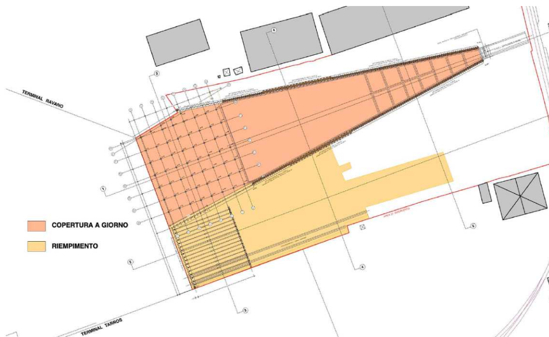
Figura 2-35 – Planimetria di progetto con distinzione dell'area di banchinaggio
