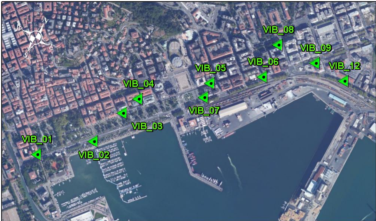
Figura 4.2 - Localizzazione rilievi vibrazioni (lato Ovest)
