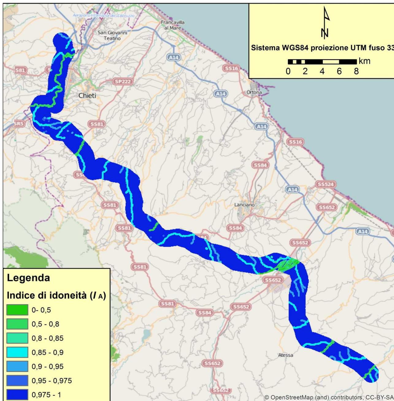
Figura 5-a. Classificazione in funzione dell'indice di idoneità ( $I_A$ ) del corridoio interessato dal passaggio dell'elettrodotto.
