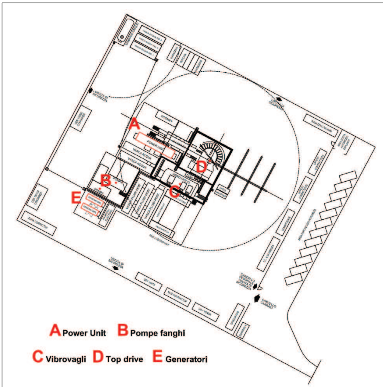
Figura 3.3.2: Layout dell'impianto con individuazione delle sorgenti sonore
