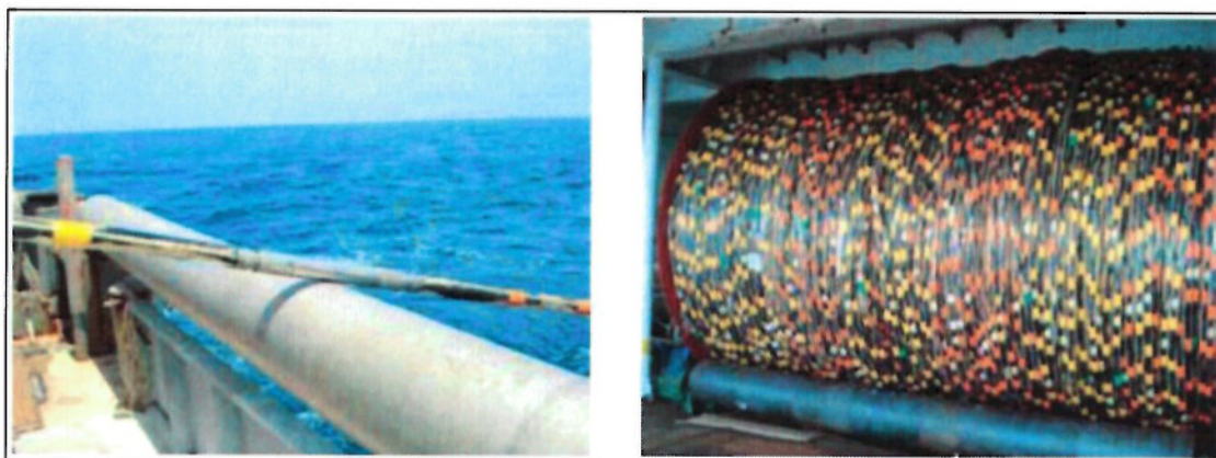
Figura 10 Esempio di Cavo Sismico o Streamer (OGP, 2011)
