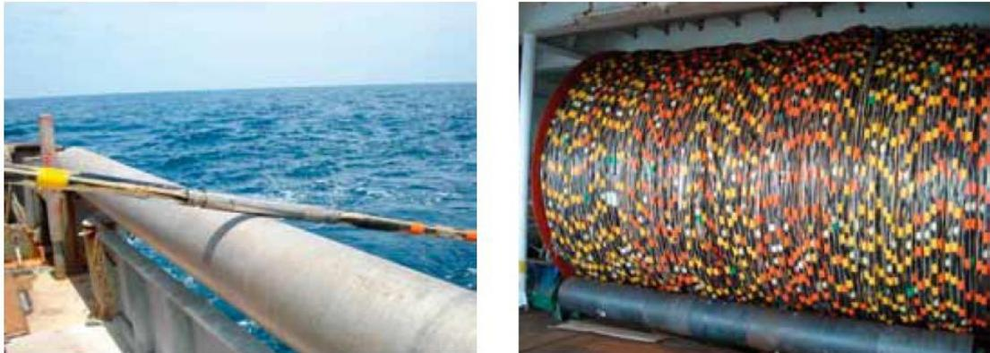
**Figura 6.5: Esempio di Cavo Sismico o *Streamer* (OGP, 2011)**
