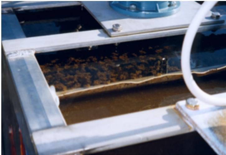
Figura 4. Flocculazione dell'acqua di controlavaggio dei filtri
