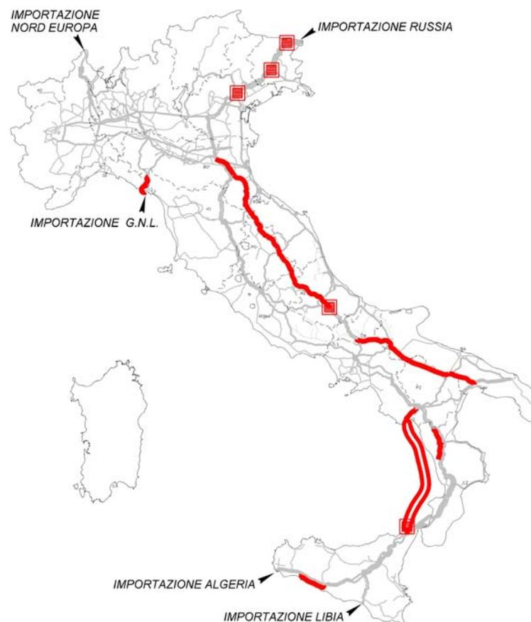
Snam Rete Gas ha previsto nel proprio piano la realizzazione di circa 1.400 km di condotte e circa 180 MW di potenza installata nelle centrali di
