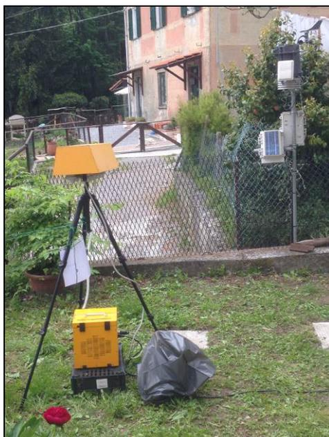
*Figura 4 - Esempio di campionamento dell'amianto Seconda Cintura nel cantiere CSL2 – Punto AMI\_CM-002.*
