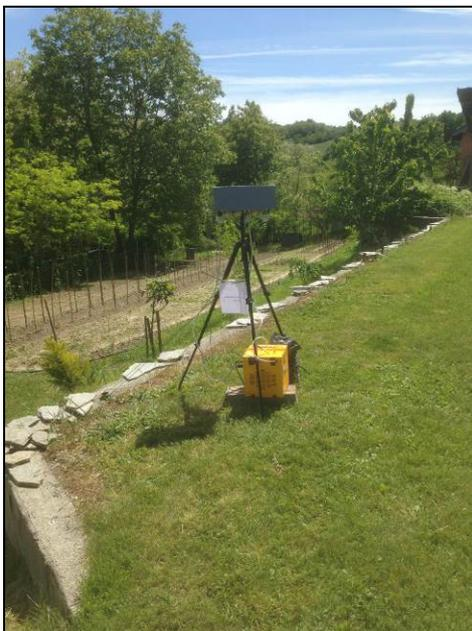
Figura 3 - Esempio di campionamento dell'amianto Prima Cintura nella galleria Nord di Valico – Punto AMI\_AR-005.
