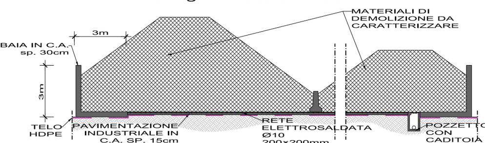
SEZIONE TIPOLOGICA AREE DI STOCCAGGIO TIPO B
