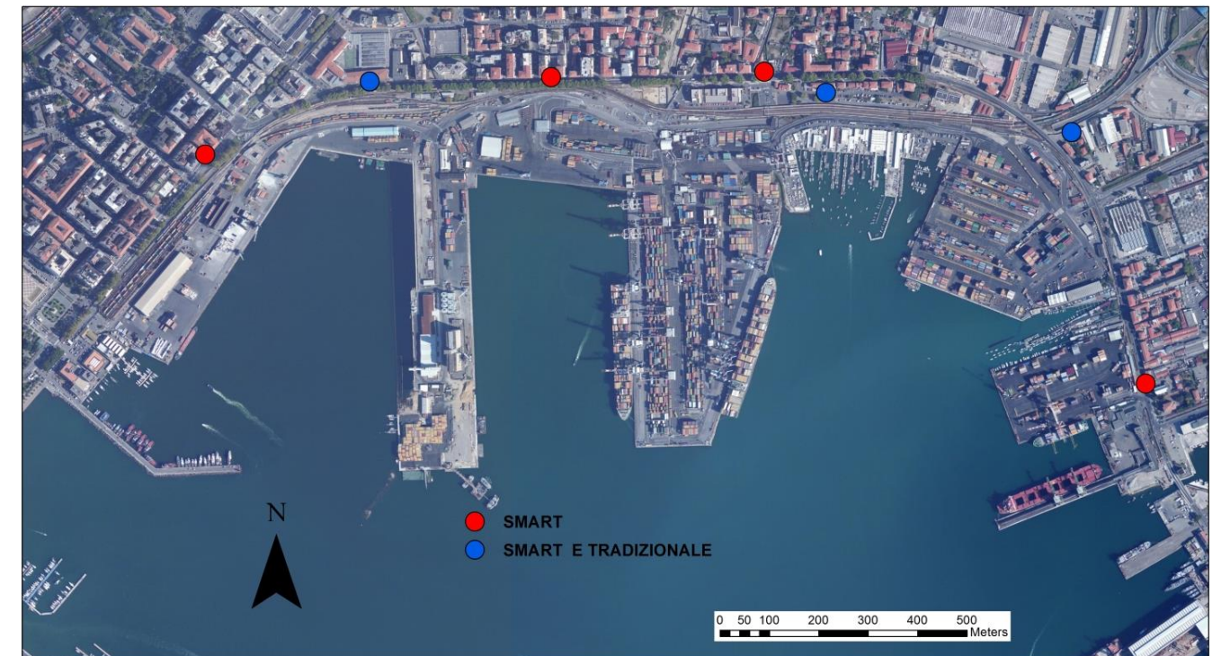
Figura 3-149 - Ipotesi di posizionamento delle centraline di monitoraggio
