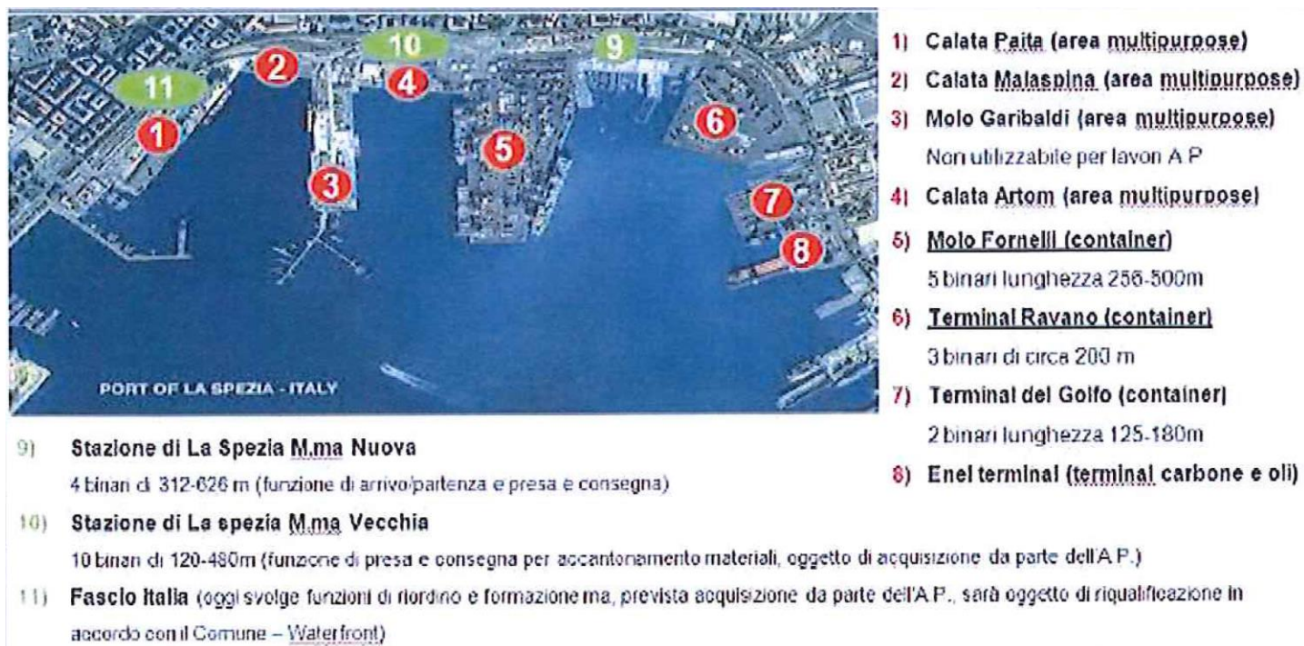
Figura 3-14 – Il sistema ferroviario a supporto del porto
