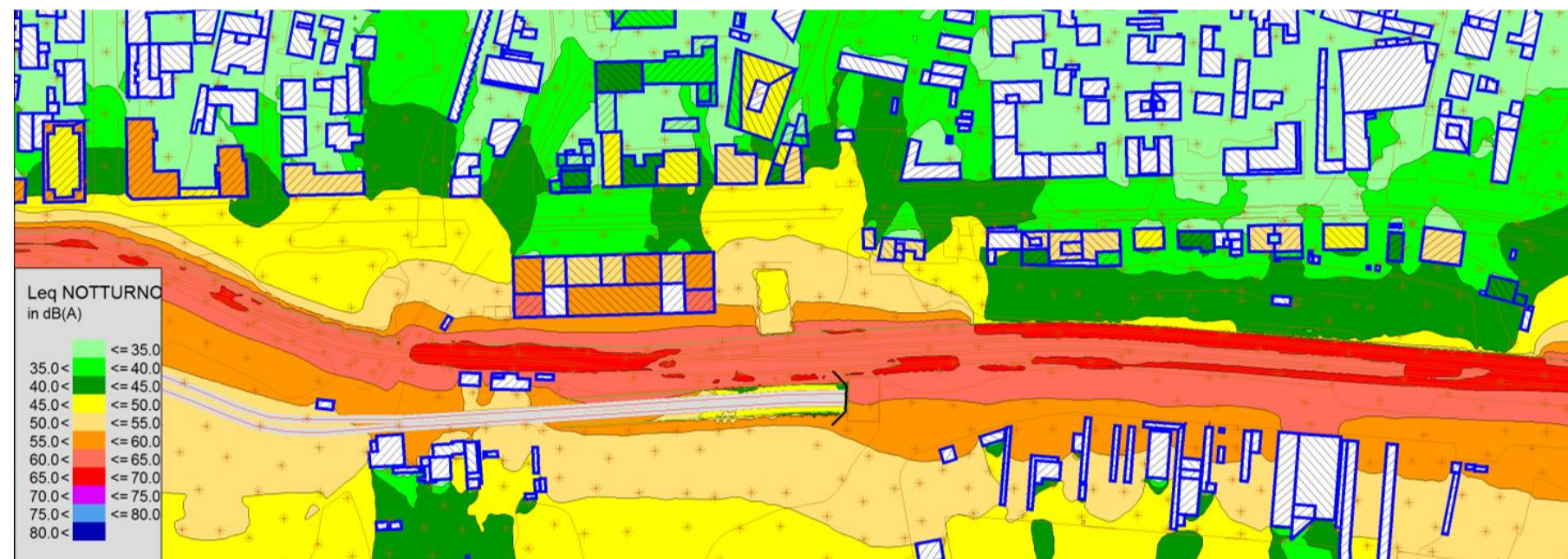
Figura 3-47 - Periodo di riferimento notturno - Mappa impatto ferroviario zona Est da via Giulio della Torre a via privata Maralunga- Stato attuale
