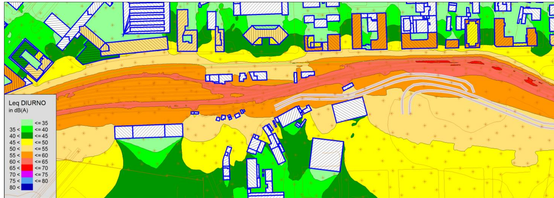
Figura 3-44 – Periodo di riferimento diurno - Mappa impatto ferroviario zona Ovest da via san Cipriano a via Giulio della Torre - Stato attuale
