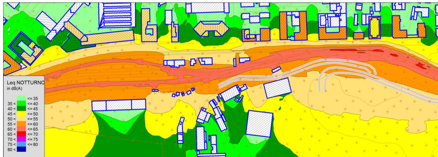
Figura 3-45 – Periodo di riferimento notturno - Mappa impatto ferroviario zona Ovest da via san Cipriano a via Giulio della Torre - Stato attuale
