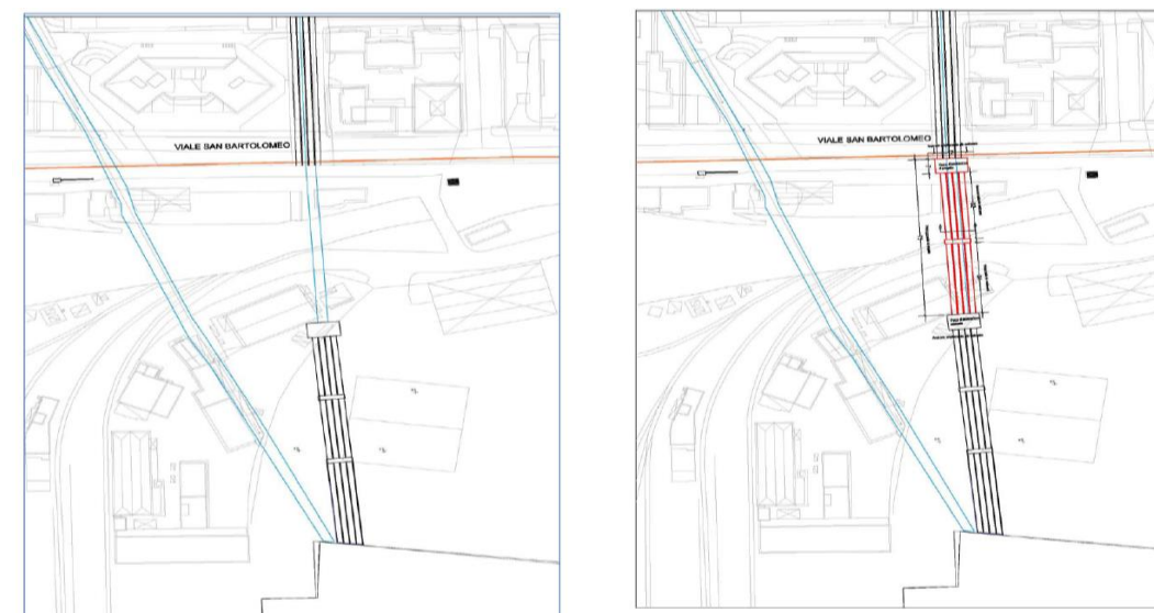
Figura 3-130: Planimetria adeguamento idraulico Fosso Rossano – Stato di Fatto e Stato di Progetto
