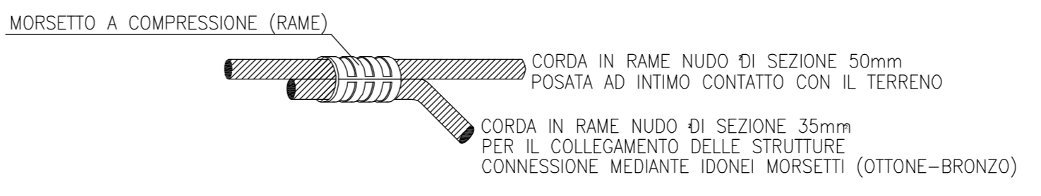
PARTICOLARE COLLEGAMENTO LINEA DI TERRA
