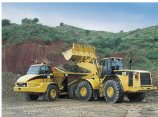
Fig. 7.6.B Esempio di pala meccanica da circa 200 kW
