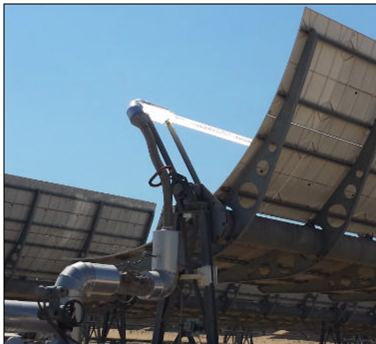
Figura 3: Esempio tubo flessibile per collegamento collettore-tubazione
