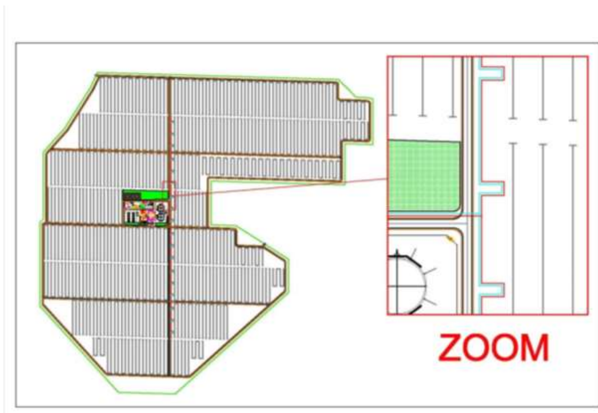
da Appendice 1 punto 4 - Figura 1: Layout Impianto CSP "Gonnosfanadiga" - Compensatori ad Omega
