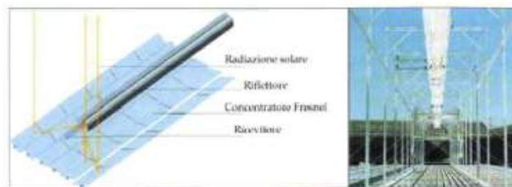
Figura 5. Il sistema Fresnel
