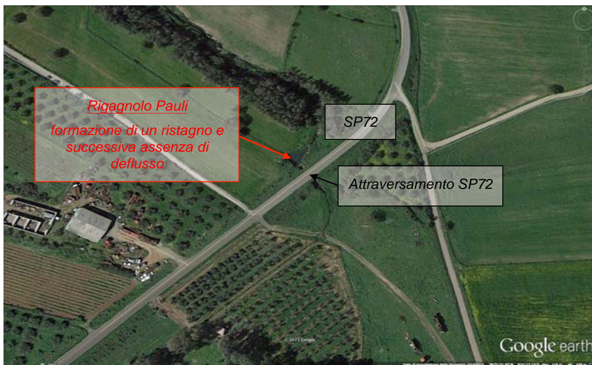
Figura 35: Rigagnolo Pauli, attraversamento SP72 e particolare del ristagno a valle dell'attraversamento
