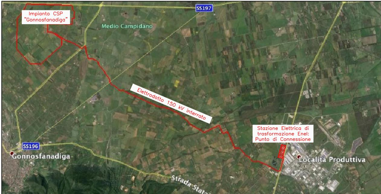
**Figura 1: Inquadramento su Ortofoto dell'Area d'Impianto e dell'Elettrodotto AT in Cavo Interrato**
