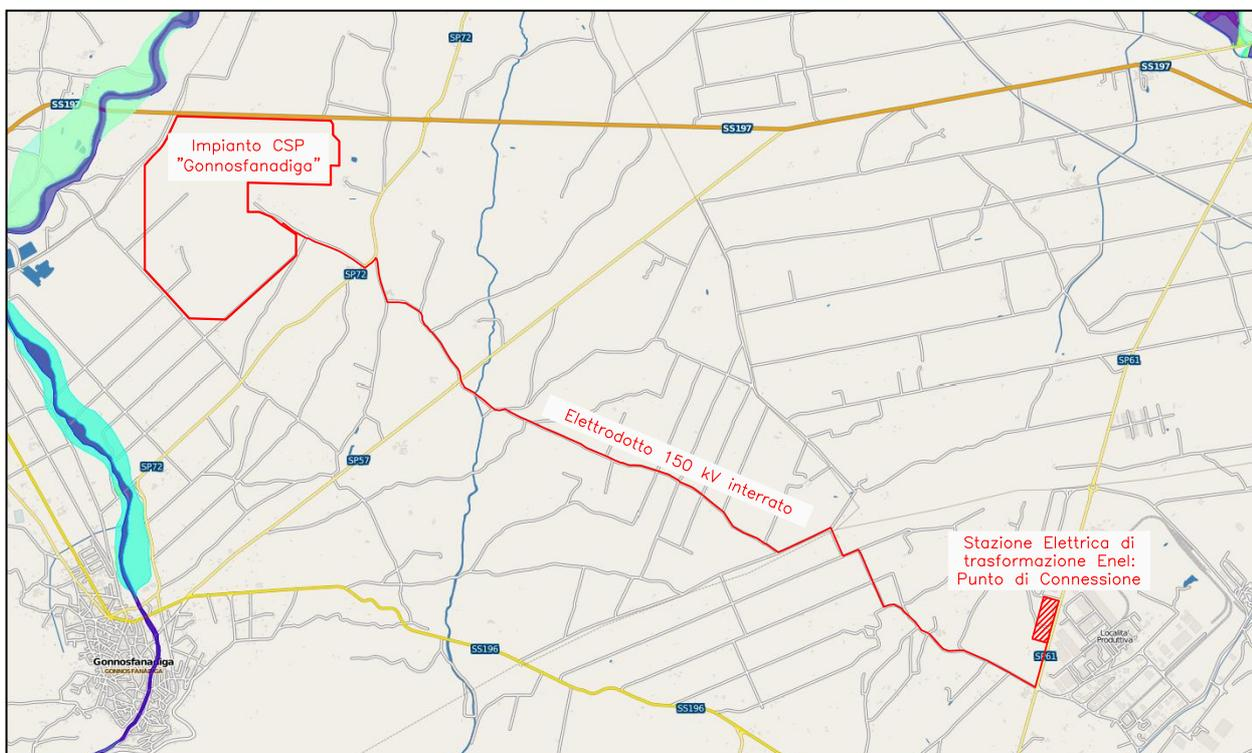
**Figura 4: Inquadramento Area d'Impianto ed Elettrodotto AT in Cavo Interrato su Piano Stralcio di Bacino per l'Assetto Idrogeologico (PAI)**
