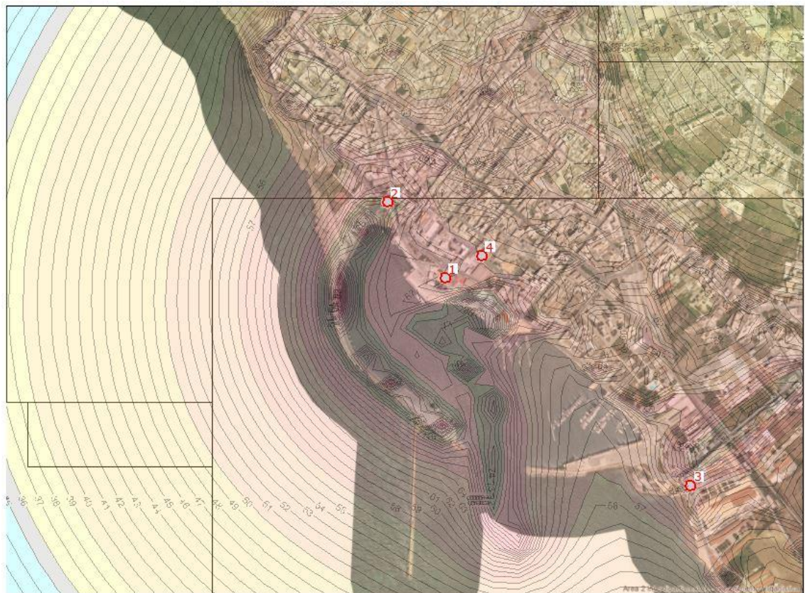
Figura 250 – Output - isofone riferito alla fase di cantiere 3 di picco con ortofoto scala di dettaglio e punti di rilievo- elaborazione Citymap – Diurno
