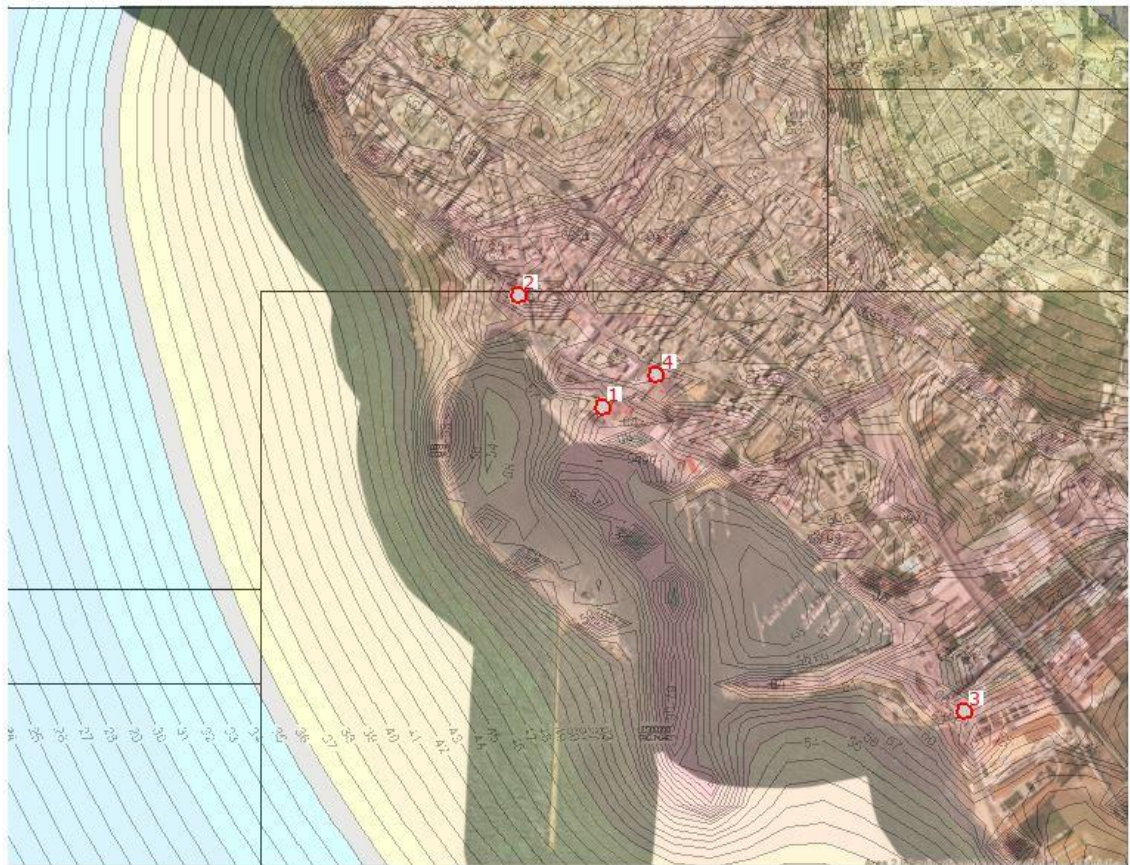
Figura 257 – Output - isofone riferito alla fase di picco di traffico navale Post Operam con ortofoto scala di dettaglio e punti di rilievo- elaborazione Citymap – Diurno
