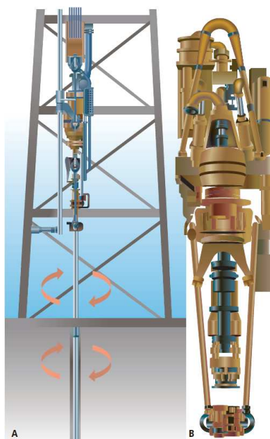
Figura 3.9: Top drive o testa motrice montata sulla torre; B, particolare della testa motrice (Fonte: Enciclopedia degli idrocarburi - ENI, Treccani).
