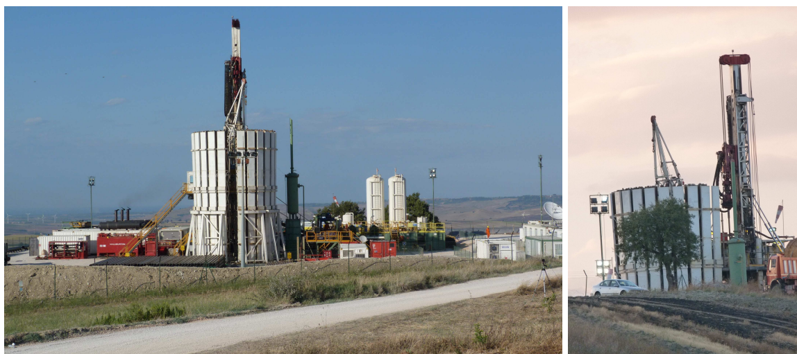
Figura 3.10: Impianto di perforazione HH 220 Leonardo (fase di workover su TT20)
