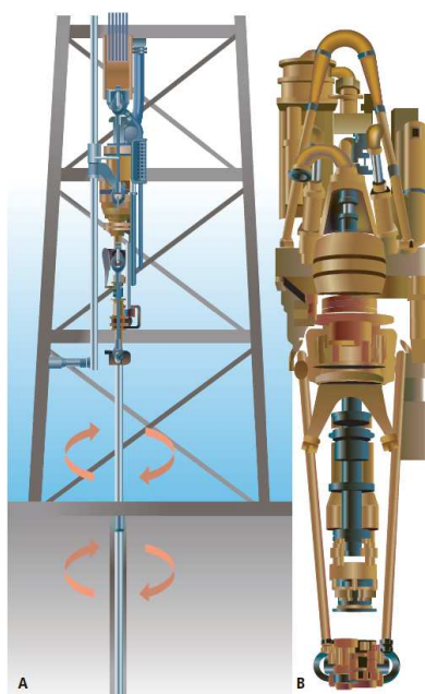
Figura 4.9: Top drive o testa motrice montata sulla torre; B, particolare della testa motrice (Fonte: Enciclopedia degli idrocarburi - ENI, Treccani).
