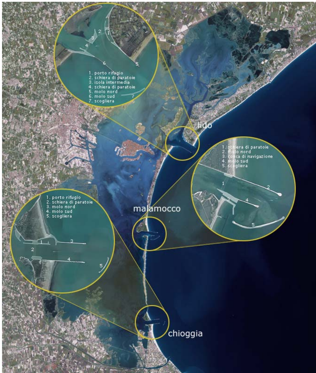
Figura 22-8 Opere previste dal Sistema Mose alle bocche di porto (Fonte: www.salve.it , ultimo accesso 15.04.2013).
