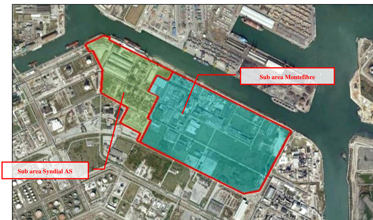
Figura 22-14 Interventi di bonifica - sub aree di intervento.
