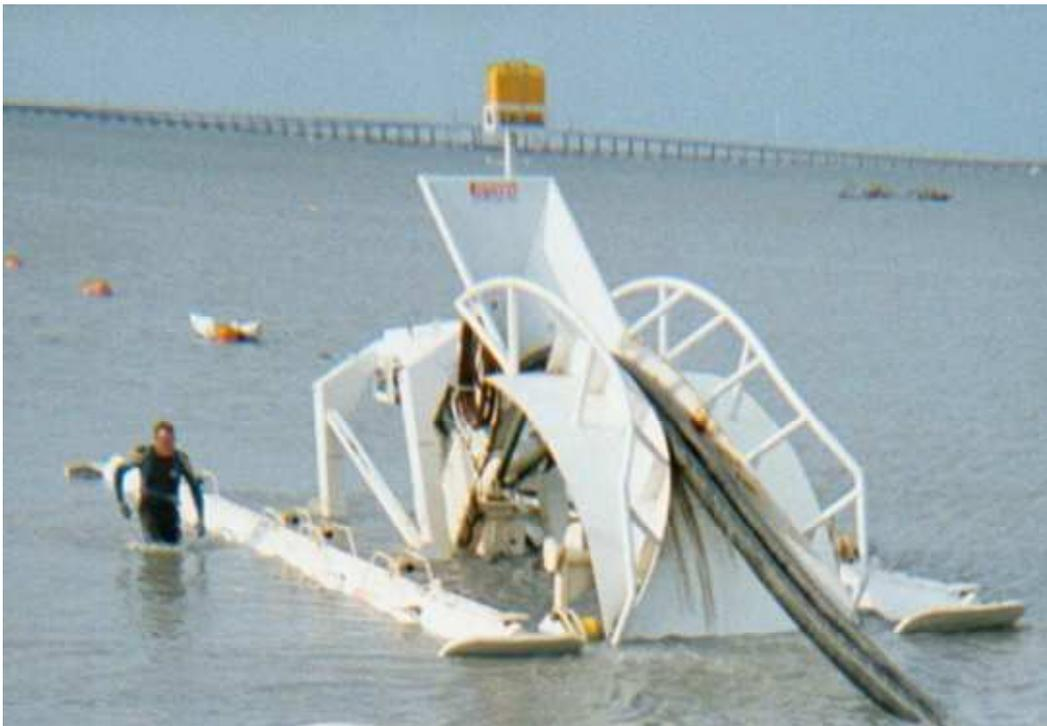
**Fig. 9** Sistemi a getto per l'interramento di cavi sottomarini ( $h > 10$ ): Hydroplow (Prysmian Proprietary).
