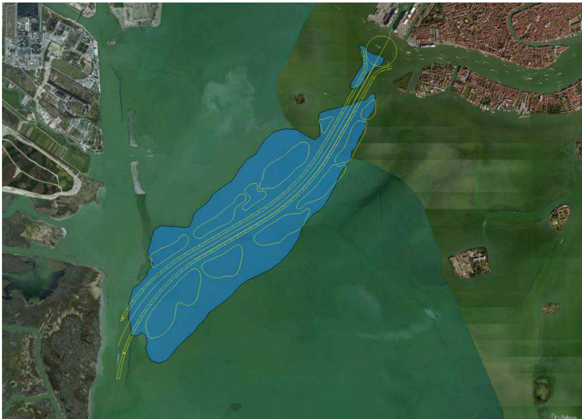
Figura 5-1. Areale di influenza sulla matrice sedimenti in termini di differenze batimetriche ad un anno dalla messa in esercizio del canale
