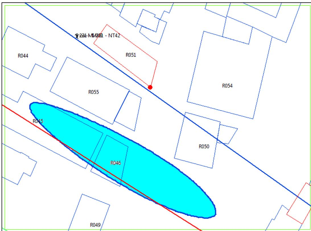
Figura 83: recettore ID 051 – scenario 4, curva isolivello dell'induzione magnetica a 3  $\mu$ T alla quota di 57 m.
