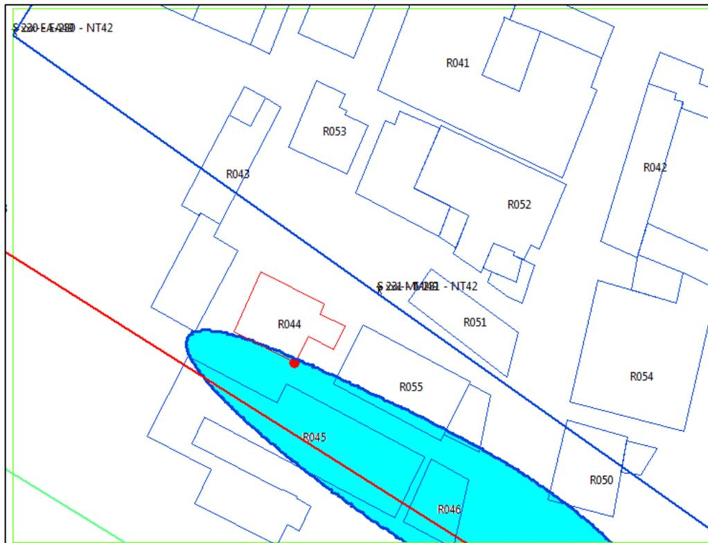
Figura 71: recettore ID 044 – scenario 4, curva isolivello dell'induzione magnetica a 3  $\mu$ T alla quota di 60 m.
