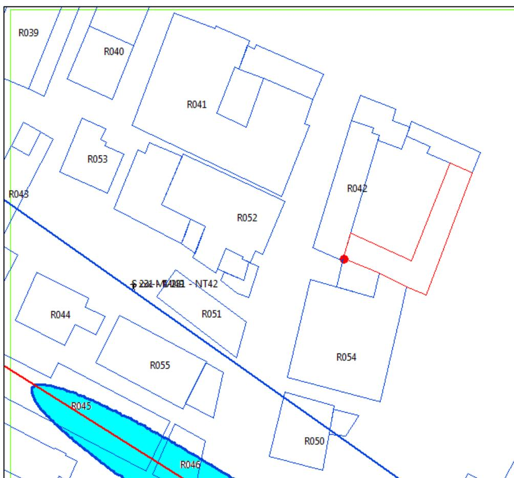
Figura 65: recettore ID 042 edificio 2 – scenario 1, curva isolivello dell'induzione magnetica a 3  $\mu$ T alla quota di 57,5 m.
