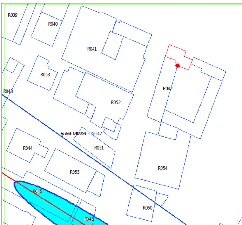
Figura 67: recettore ID 042 edificio 4 – scenario 1, curva isolivello dell'induzione magnetica a 3  $\mu$ T alla quota di 57,5 m.
