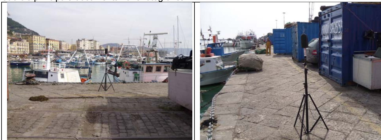
Figura 5.4 – Posizionamento della strumentazione impiegata nel punto R02 (prima campagna)
