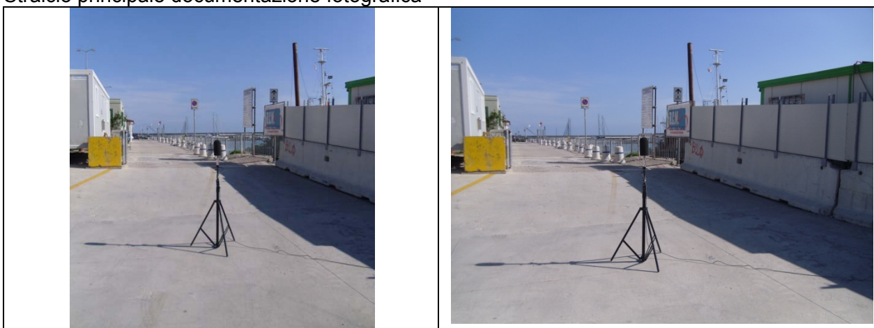
Figura 5.9 – Posizionamento della strumentazione impiegata nel punto R07 (prima campagna)
