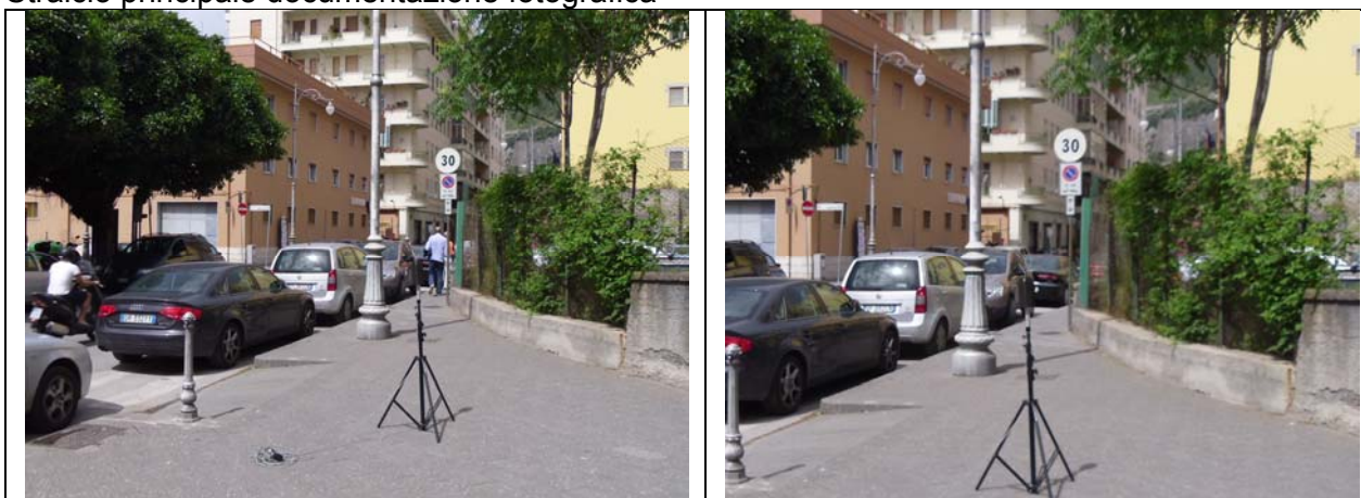
Figura 5.28 – Posizionamento della strumentazione impiegata nel punto R08 (terza campagna)
