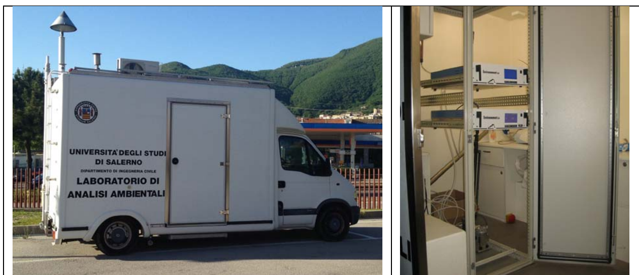
Figura 4.4 – Analizzatori installati all'interno del Laboratorio Mobile del Dipartimento di Ingegneria Civile dell'Università di Salerno
